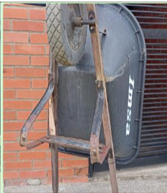
Maderas rotas, herraje oxidado, cajón amarrado con alambre.
