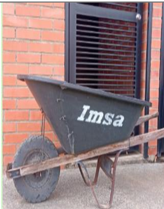
Maderas rotas, herraje oxidado, cajón amarrado con alambre.
