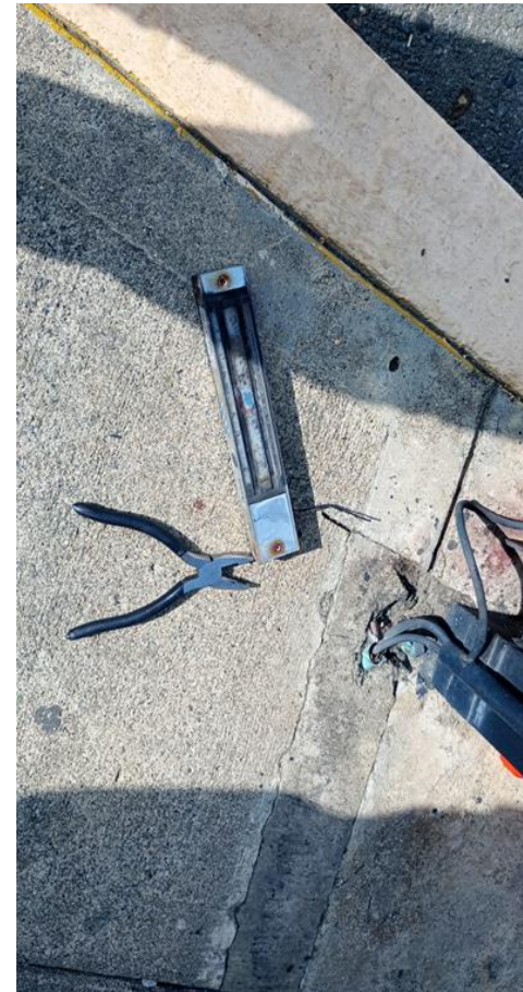
ELECTRO IMAN DAÑADO
